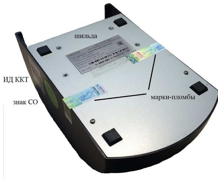
Рис.2 Места установки марок-пломб и место пломбировки ОБ ПТК
