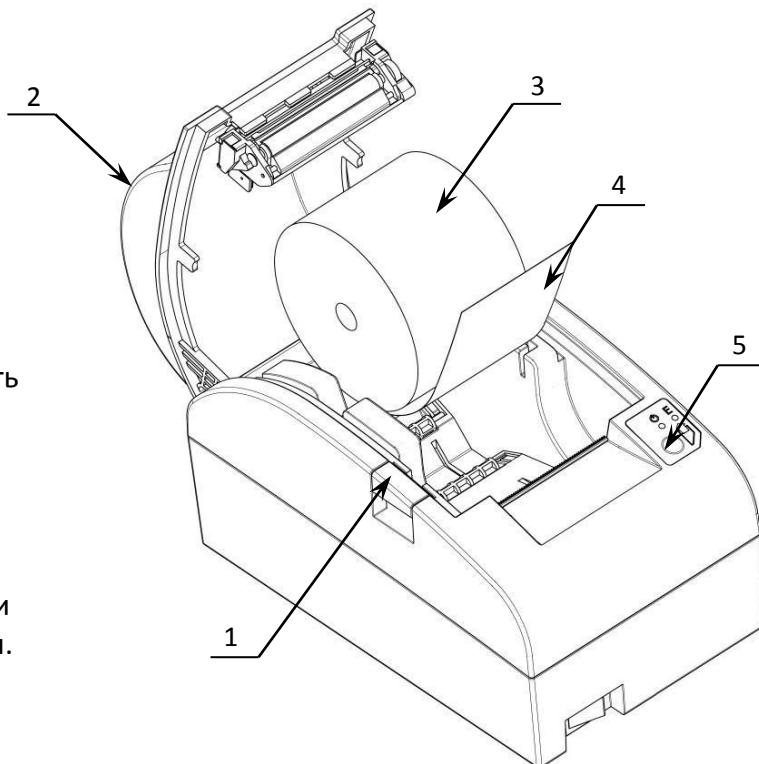
Рисунок 9. Заправка бумаги при горизонтальной установке ККТ
