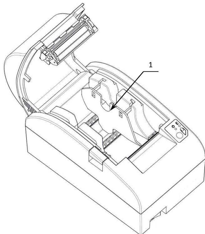
Рисунок 11. Установка ограничителя бумаги
