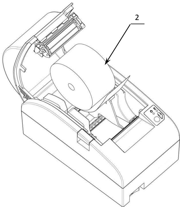
Рисунок 12. Установка ЧЛ шириной 44 мм
