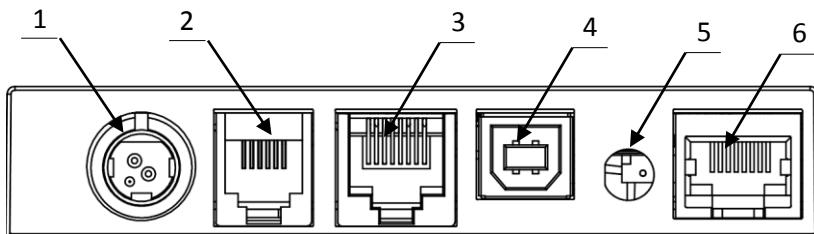
Рисунок 4. Разъемы для подключения внешних устройств к ККТ
