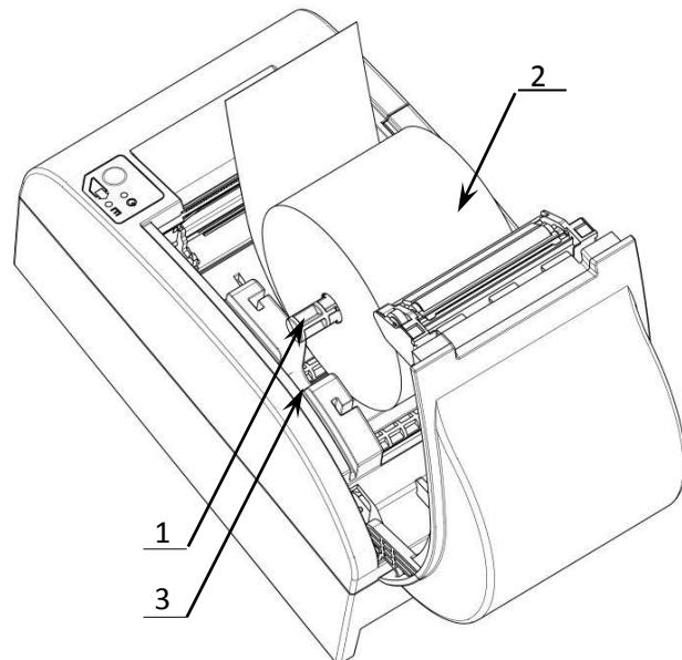
Рисунок 10. Заправка бумаги при вертикальной установке ККТ
